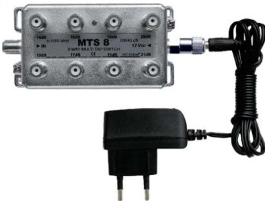
Der **MTS 8** kann an beliebiger Stelle im TV-Kabelnetz eingesetzt werden. Mit ihm kann der Rückweg (Upstream) um 6 dB oder 40 dB und der Vorwärtsweg (Downstream) um 40 dB gedämpft werden. Das Schalten erfolgt über den Rückwegmanager **RKM-TX87** oder **RKM-Server / RKM-EG** mit **KFG 2** von der Kopfstelle aus vorwärts auf der Frequenz 87,3 MHz zum Transponder im **MTS 8**.
