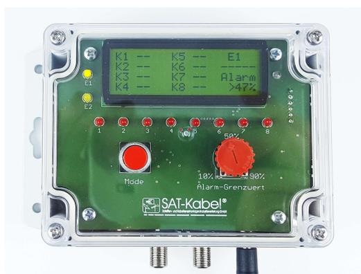
**FKMD-8-SBU** für BUS-Anschluß an die Alarmzentrale.
