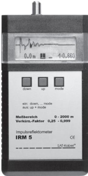
Das prozessorgesteuerte Impulsreflektometer *IRM 5* mit LCD-Display dient der Fehlerortung und Überprüfung von Nachrichten- und Energieleitungen. Zur genaueren Analyse wird zusätzlich die Rückflusdämpfung bei Koaxialkabeln ermittelt. Es ist handlich und leicht zu bedienen.
