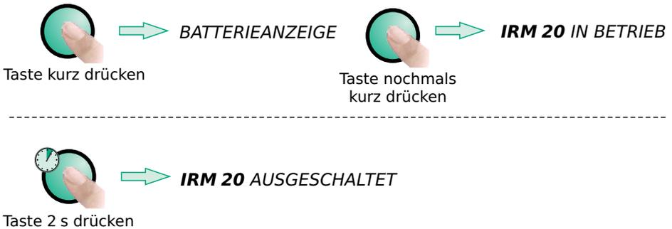
Ohne Bedienung schaltet sich das *IRM 20* nach 2 Minuten automatisch aus. Sinkt die Batteriespannung auf 5,8 V, erfolgt eine Einblendung im Display (Batteriesymbol). Bei 5,5 V schaltet das *IRM 20* ab. Beim erneuten Einschalten zeigt das *IRM 20* den zuletzt benutzten Speicherplatz an.
