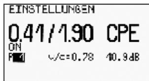
2 | Durch kurzes Drücken der Taste ESC sind die zu verändernden Parameter anzuwählen (invertierte Darstellung) und mit den Tasten LINKS und RECHTS zu ändern. Nicht benötigte Speicherplätze können dabei mit dem Parameter »ON« oder »OFF« ein- und ausgeblendet werden. Ausgeblendete Speicherplätze erscheinen beim Einschalten nicht. Die veränderbaren Parameter sind:
