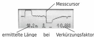
In der dritten Einstellung kann ein Filter zur Unterdrückung von Störungen zugeschaltet werden. Das verlangsamt jedoch den gesamten Messvorgang.
