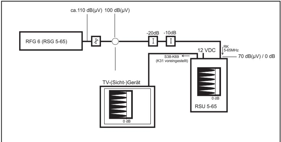
Mit dem RK-Spektrumgenerator RSG 5-65 und dem RSU 5-65 vorgeschaltete Dämpfungsglieder wird der benötigte RK-Pegel eingestellt und mit 0dB definiert.
