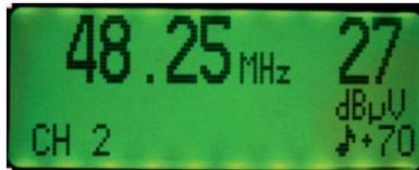
Bild 2: BK mit Ton- und LED- Anzeige im Pegelmodus
