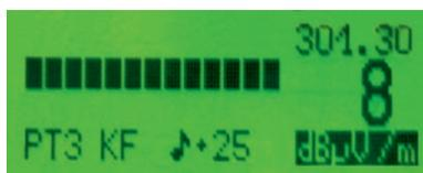
Bild 3: KFG mit Ton- und LED-Anzeige Im Feldstärkemodus
