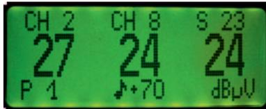
Bild 1: 3-KANAL mit Ton- und LED- Anzeige im Pegelmodus
