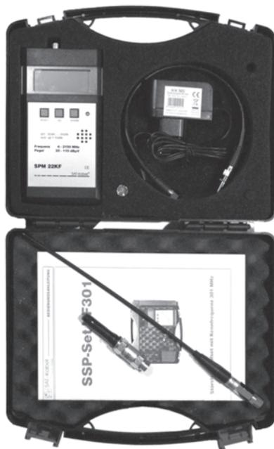
Störstrahlprüfset für Kennfrequenz 301 MHz
