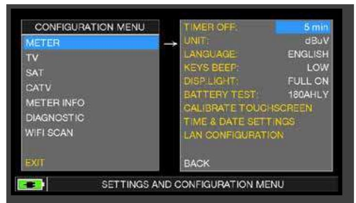
Berühren Sie im "VOLUME" Menü "CONFIGURATION MENU", dann "METER" und setzen Sie den gewünschten "TIMER OFF" Wert. Das Messgerät schaltet sich automatisch bei Inaktivität nach 5, 10, 15 oder 30 Minuten aus. Drücken Sie eine beliebige Taste um den Zeitzähler zurückzusetzen und die Abschaltung zu verhindern.
