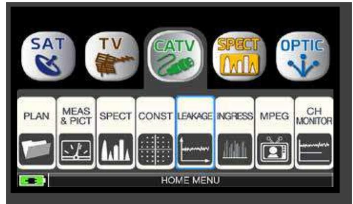
Tippen Sie "CATV" und dann "LEAKAGE" oder benutzen Sie das Drehrad.
