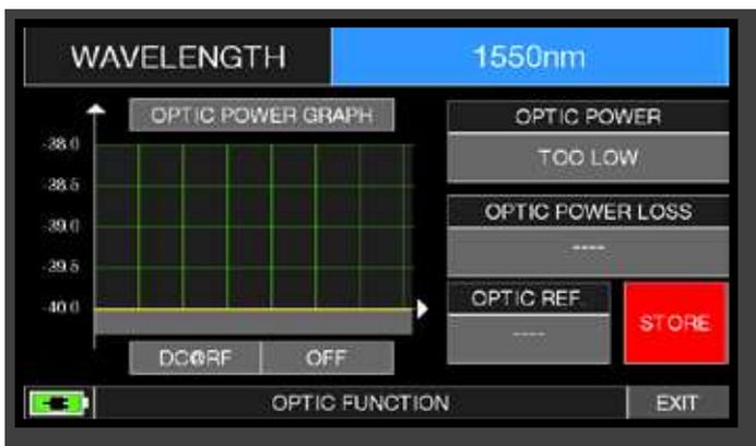
Tippen Sie auf "WAVELENGTH" (Wellenlänge) und wählen Sie die gewünschte Wellenlänge, z.B. 1550 nm.
