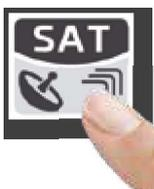
Drücken um zyklisch zwischen den SAT Modi zu schalten: Messungen, Konstellationsdiagramm.
