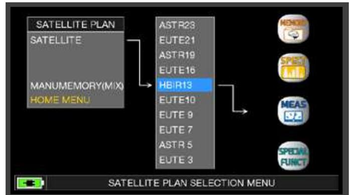
Tippen Sie direkt auf den gewünschten Satelliten oder benutzen Sie das Drehrad. Zum Abschluss wählen Sie zwischen "MEAS" für Messungen oder "SPECT" für die Darstellung des Spektrums.
