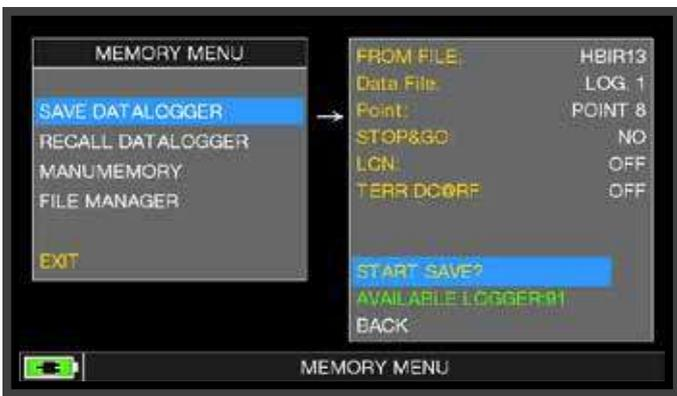
Tippen Sie "SAVE DATALOGGER". Setzen Sie nun die gewünschten Parameter und wählen Sie "START SAVE?" um eine neue Logger-Datei zu generieren.
