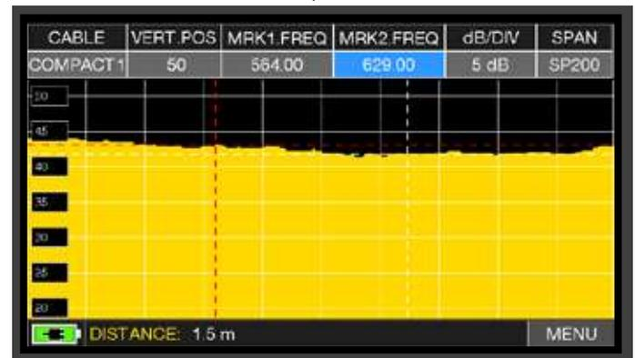
Im DISTANCE Feld (Entfernung) kann die Fehlanpassung des Kabels abgelesen werden: in diesem Beispiel 1.5 m.
