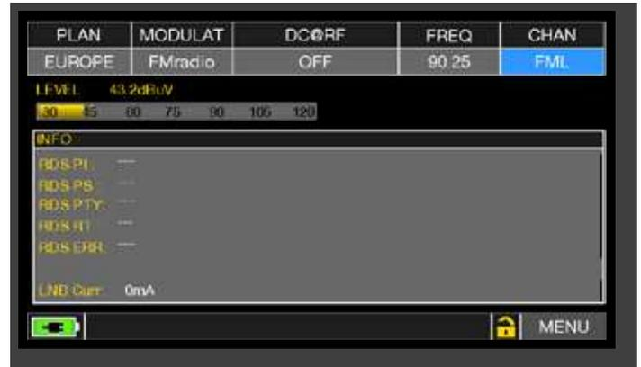
Berühren Sie "CHAN" und setzen Sie den "FML" oder "FMH" Kanal.
