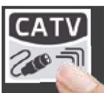
Drücken um zyklisch zwischen den CATV Modi zu schalten: Messungen, Konstellationsdiagramm.
