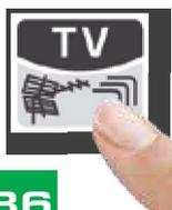
Drücken um zyklisch zwischen den TV Modi zu schalten: Messungen, Konstellationsdiagramm, Echo und MER vs TRÄGER.
