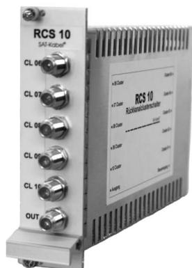
Der **RCS 10** ist der eigentliche Rückkanal-Cluster-Schalter, über den das Schalten der einzelnen Rückkanalsignale erfolgt. Diese werden dann über seinen Ausgang dem **RSA 5-65 C** zur Auswertung zugeführt. Die Steuerung der Schalter erfolgt durch die **CSE 7**. Es sind maximal 10 Rückkanalcluster an einen **RCS 10** anschließbar. Nicht benötigte Eingänge können mit einem F-Widerstand von 75 Ohm versehen werden, müssen es aber nicht.
