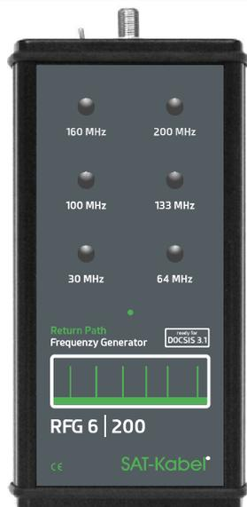
Der **RFG 6** ist ein Signal-Generator, er liefert 6 einzeln schaltbare Festfrequenzen, diese können mit dem Analyser **RPA 5-210** grafisch dargestellt werden. Das System dient zum Einstellen und Überwachen des Rückwegbereichs in CATV-Anlagen. An der F-Ausgangsbuchse beträgt der Pegel 110 dBµV.
