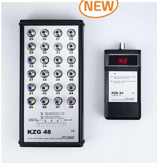
Für mehr als 24 Leitungen haben wir als Erweiterungsmöglichkeit den Sender KZG 48 entwickelt, dieser sendet die Nummerierung 25-48.
