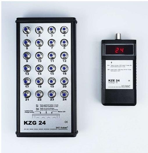
Dieses Gerät dient der Zuordnung von Koaxialkabeln (Antennenkabel) einer Hausinstallation zu den entsprechenden Anschlussdosen und umgekehrt. Die Zuordnung ist über Stern- und Baumverteilungen möglich.
