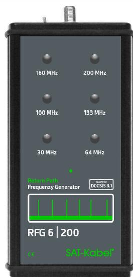
Der **RFG 6** ist ein Signalgenerator für die CATV-Rückweg-Analyse. Es verfügt über 6 wählbare, vordefinierte Frequenzen die in der Kopfstelle mit dem Spektrum-Analysator **RPA 5-210** angezeigt und gemessen werden können. Das System dient zum Einstellen und Überwachen des Rückwegbereichs in CATV-Netzen.
