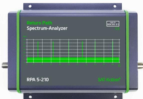
Der Rückweg-Spektrum-Analysator scannt den Frequenzbereich von 5 bis 210 MHz und überträgt die Messwerte mit USB zum **RKM-Server**. Mit diesem ist die Weiterverarbeitung, Speicherung der Daten sowie Alarmierung möglich. Unabhängig vom Betriebssystem erfolgt die grafische Darstellung, Steuerung und Konfiguration per Web-Browser.
