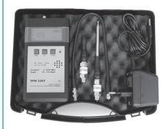
Dieses Störstrahl-Prüfset enthält in einem handlichen Koffer alle notwendigen Geräte und Hilfsmittel für einen Praktiker zum Suchen und Erkennen von Störstrahlung aus HF-Netzen. Zusätzlich kann das dazugehörige *SPM 22 KF* eine im Kabelnetz vorhandene eigene Kennung anzeigen.
